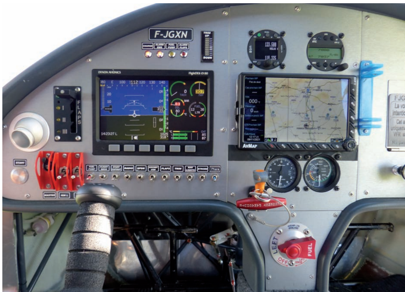
La machine essayée est équipée d'un EFIS/EMS Dynon et d'un GPS AvMap. Au-dessus de ce dernier, on trouve la radio et le transpondeur et, en dessous, un badin et un altimètre analogiques de secours. À gauche, la commande des volets électriques, les contacts et le bouton du démarreur.
